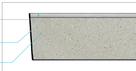
Fabrieksmatig aangebrachte toplaag op een calciumsulfaat paneel.
